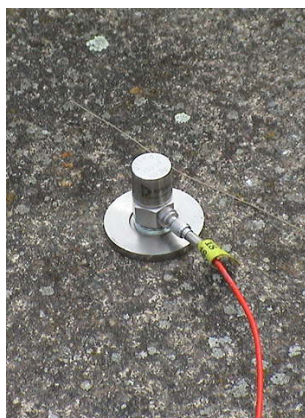
(a) Accéléromètre Dytran collé sur une dalle en béton
