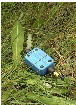
(b) Géophone Geospace disposé verticalement au sol
