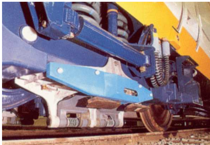
FIG. 2.7 – Bogie de l'Eurostar avec patin 3 e rail
